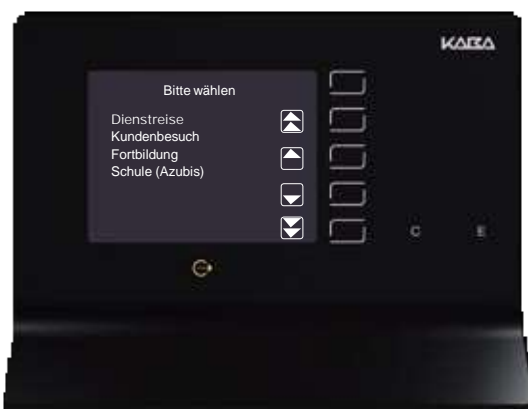
Beispiel Dienstgang - Schritt 3 Nach erfolgreicher Buchung erscheint die Liste der Abwesenheitsgründe. Der Mitarbeiter wählt und bestätigt die Auswahl mit „E“ (Enter).
